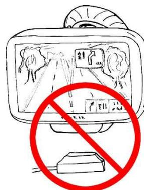
**Fixez fermement** l'antenne GPS (par exemple, avec du ruban adhésif double-face) pour vous assurer qu'elle ne bougera pas durant le fonctionnement.
