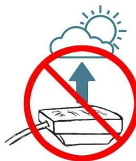
L'antenne GPS ne doit pas être placée sous ou à proximité de **structures métalliques solides** ni à proximité d'autres **appareils GPS** et **antennes**.
