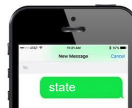
d) Apague la ignición del vehículo y reenvíe el SMS con el comando ESTADO. En el SMS de respuesta, verifique que la entrada IGNITION no esté activa **2** (ENTRADAS 0/0/0).
