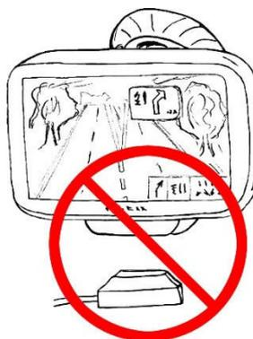
Fije firmemente la antena GPS (por ejemplo, cinta adhesiva de doble cara) para asegurarse de que no se moverá durante la operación.
